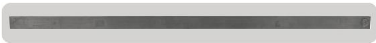
图1-14 来自中美洲的一根标准尺（长约33英寸，1846年制造）
