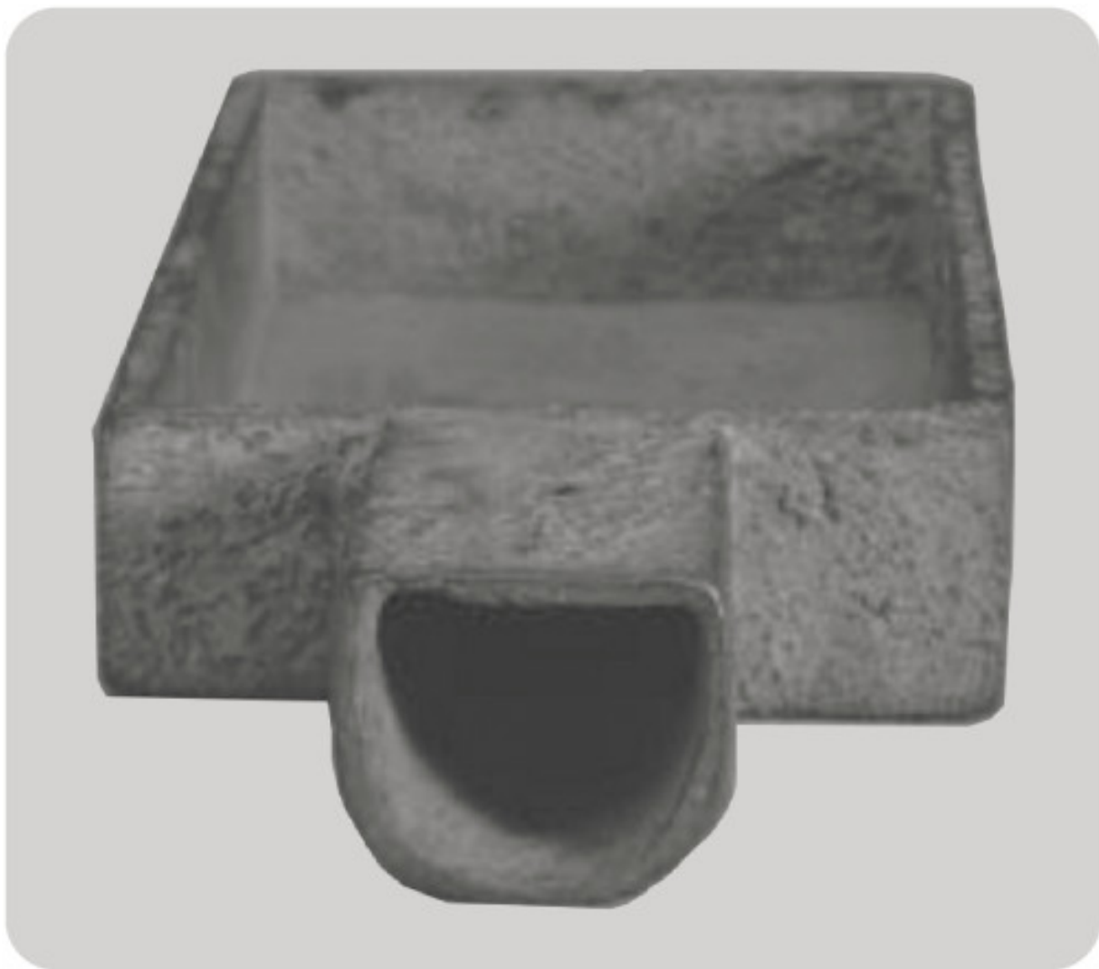
图1-4 秦国商鞅铜方升（现藏上海博物馆。全长12.47厘米，宽6.97厘米，深2.31厘米，容积为202毫升）
