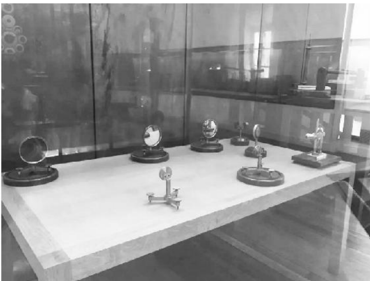
图2-8 1862年傅科利用光反射测量光速的装置（该装置为复制品，现藏法国国立工艺与科技博物馆）
