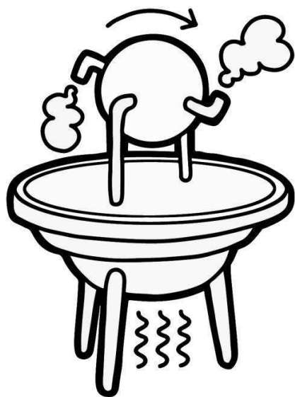
图23 一种本可以给古希腊文明提供能量的机械——汽转球
