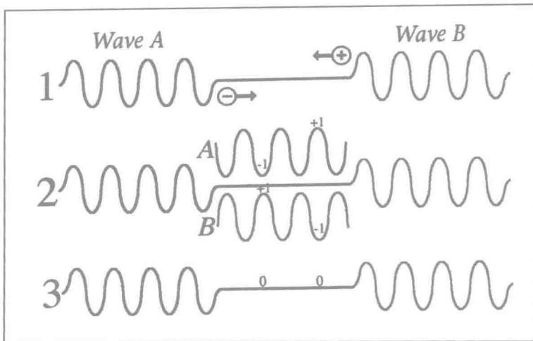
相消干涉。在图 1 中, 来自第一个鹅卵石的波纹标记为 A 波, 从左至右移动。从右至左移动的 B 波代表紧随第一个石头之后扔入的第二块石头引起的波纹。两个石头不是同时击中水面的, 因此, 在两个波合并的界面, 它们不会对齐, 而是会“异相”。在图中, 波 A 带有负振幅, 波 B 带有正振幅。如图 2, 当它们合并时, 每个波都是对方的镜像, 一个波的高振幅( +1 )和另一个波的低振幅( -1 )对齐了, 反之亦然。如图 3 所示, 两个波的幅值互相抵消, 因此复合波的振幅是 0, 即, 根本没有波——它是平的!
