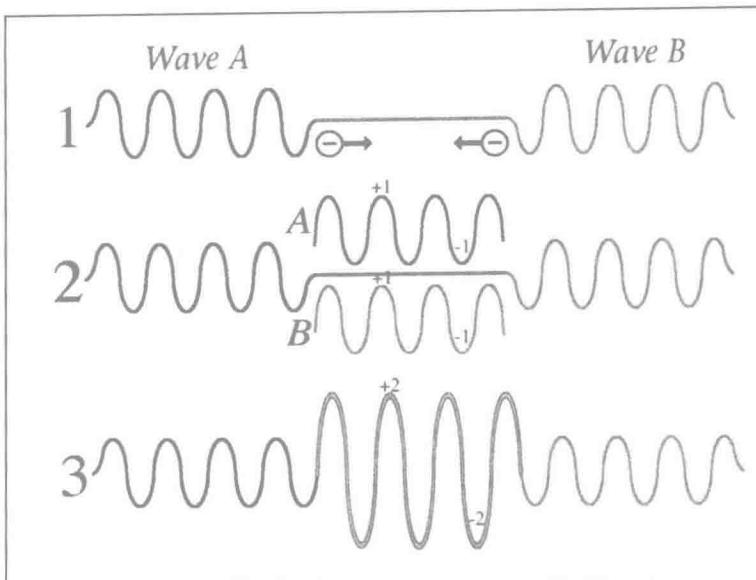
相长干涉。在 1 的上方,两个波纹穿过水面朝对方移动。如图所示,A 波和 B 波都携带它们的同相波朝对方移动,这种情况下,两个波都带有它们的负振幅。它们的循环模式是对齐的。在两个波纹相遇的界面,波合并了。为说明合并的结果,在图 2 中,一个波画到了另一个波上方。A 振幅为 +1 的地方,B 的振幅也是 +1;把两者相加,该处的复合波的合成振幅是 +2。同样,A 振幅为 -1 的地方,B 的振幅也是 -1;相加之后,总的振幅是 -2。图 3 绘出了合成功后振幅更高的复合波。
