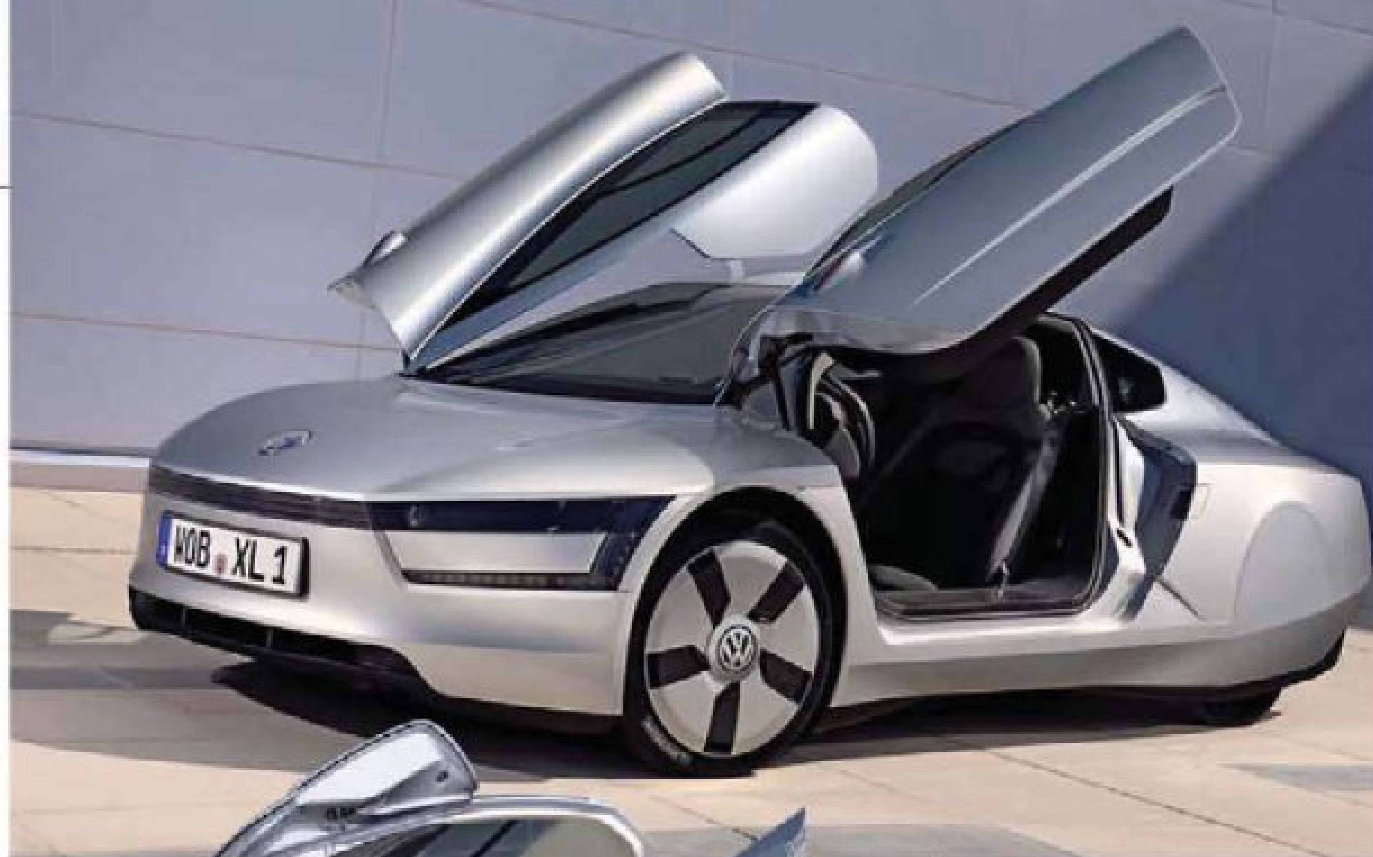
Koła w tym VW zasłonięto, żeby samochód był bardziej aerodynamiczny i palił jeszcze mniej paliwa
