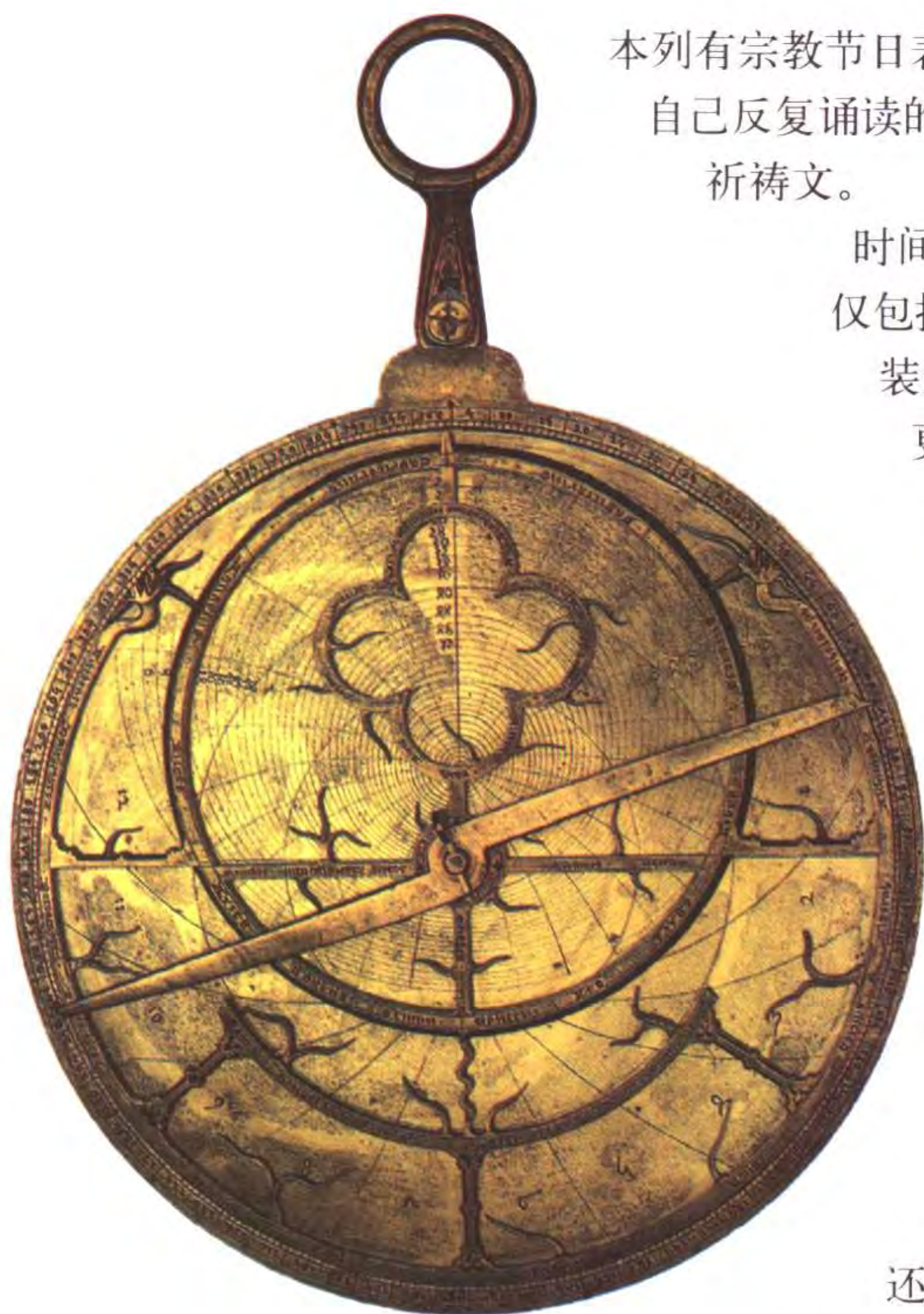
图 68 布莱克内星盘，英国，1342 年。黄铜与其他金属，直径 21.8 厘米。伦敦大英博物馆藏。
